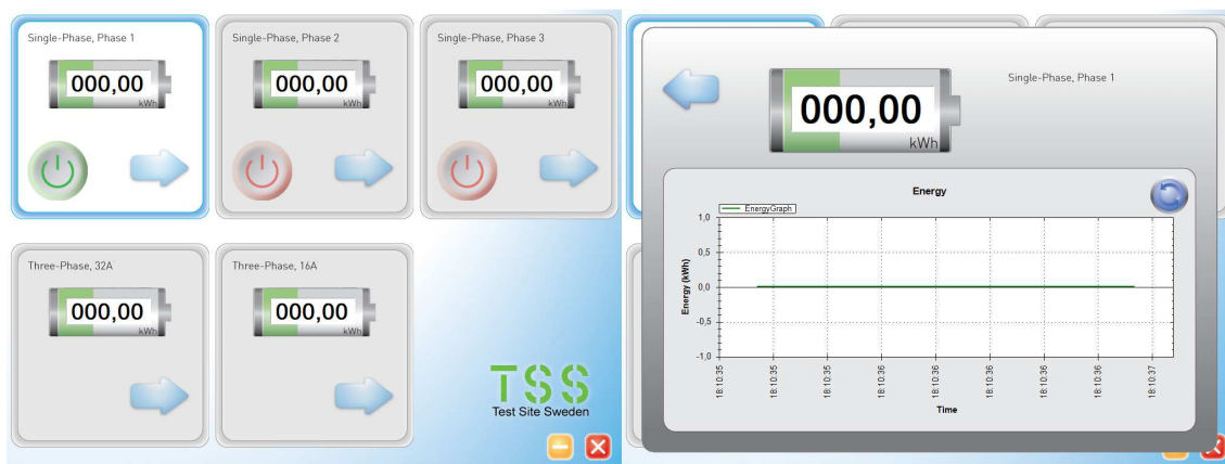
Fig. 4.16 Bild på två fönster från den ChargeAlyzer-specifika mjukvara som dels används för att aktivera respektive uttag och dels för att ge användaren en graf på överförd energi.
