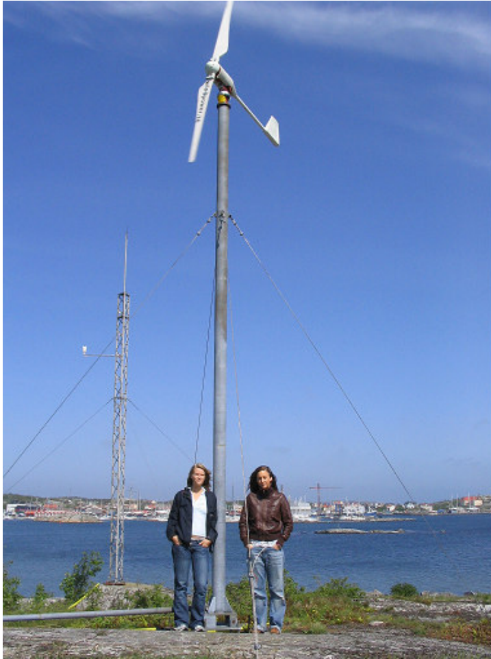
Figur 3.2 Vindkraftverk med vindmast i bakgrunden.
