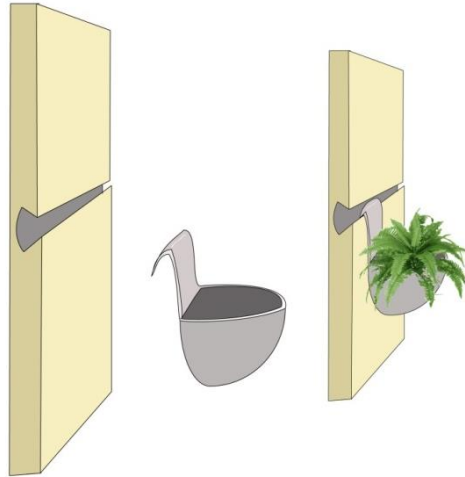
Figur 5.11 - En skena skapas direkt i materialet för att kunna trä i växtamplar
