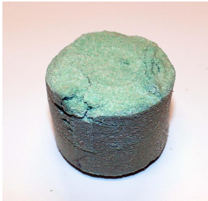
Figur 3.3 - Brikett av Divinycellspån
