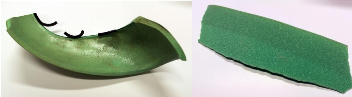
Figur 3.1 - Gjuhud och tunn bortsågad skiva av Divinycell
