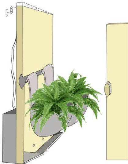
Figur 5.12 - Bevattningssystem samt infästning för dold konstruktion sedd till höger
