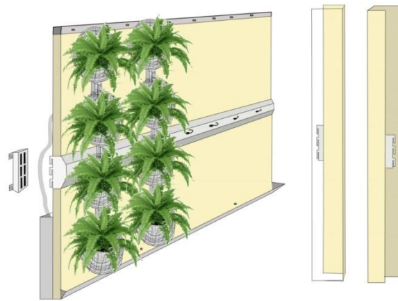
Figur 5.8 - Bevattningsystem överst, avslutningslist för dold konstruktion till höger på bilden
