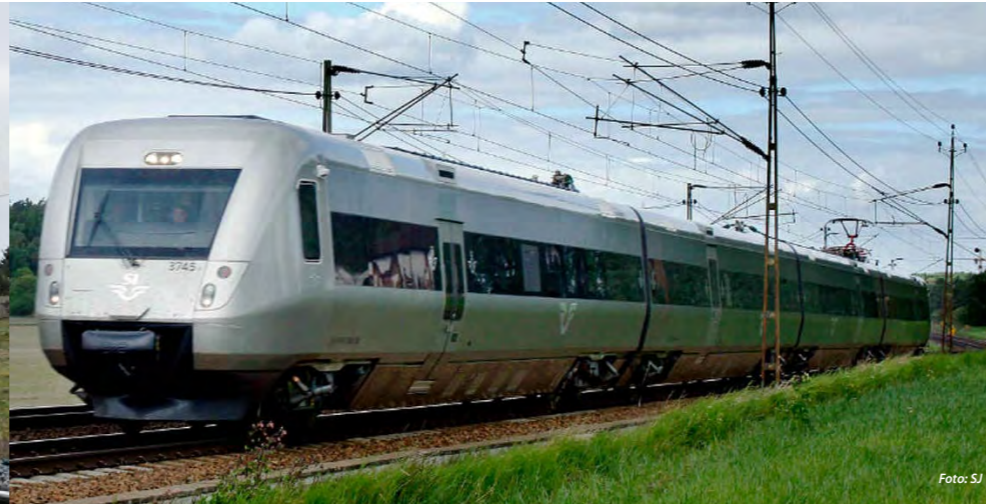
SKILLNADER Medan alla moderna spårvagnar har inklädda hjul så har de svenska tågen, som SJ 3000 från Bombardier, fortfarande öppna hjulkonstruktioner. I Japan ställer man tydliga emissionskrav vad gäller ljud, vilket medfört att snabbtåget Shinkansen nu har inklädda hjul för att minska ljudet mot omgivningen.
